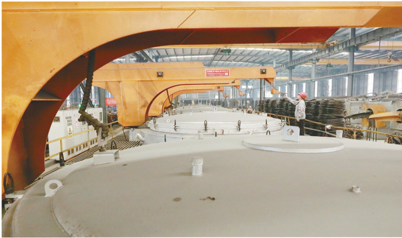
图为任泽区龙泉剑厚力五金园内热处理车间的球化退火设备。该设备可降低金属材料的硬度，改善其切削加工性能，使产品品质更稳定。 范凯迎摄
