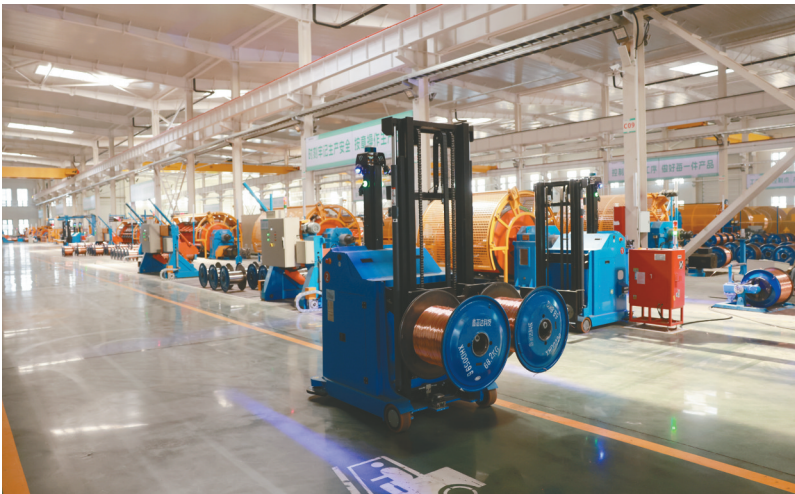
在缆芯高导河北科技有限公司共享基地内，智能AGV搬运机器人正在搬运线缆盘。
